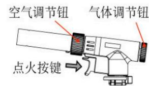
**△ 注意** 夏季高温或使用新气瓶时,气压有时较高,难以点火,此时,将气体旋钮反向旋转少许,并重试点火操作。低温时,火焰可能较小,此时,请将气瓶温度恢复到室温再使用。
