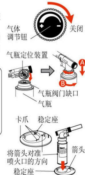
**△ 注意** ●如安装时气瓶倾斜,液态气体就会进入喷枪气管,导致点火时火焰变大。务必在直立状态下安装气瓶。●气瓶安装后,如结合部位发出“嘶嘶”的漏气声或闻到泄露的气体时,请卸下气瓶。如结合部位有异物附着,可清除异物后重新安装。**如仍有漏气现象,请停止使用,并联系经销商进行修理。**
